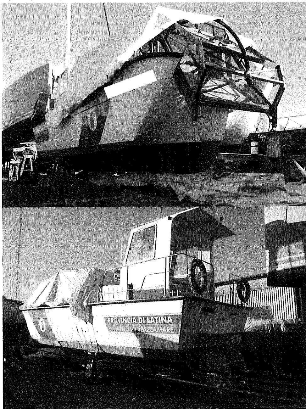
Lo scafo esterno opera morta e la coperta si presentano in buone condizioni, sarà tuttavia necessario un restauro a ritocchi del gelcoat ; rimozione di adesivi deteriorati e una lucidatura professionale !
