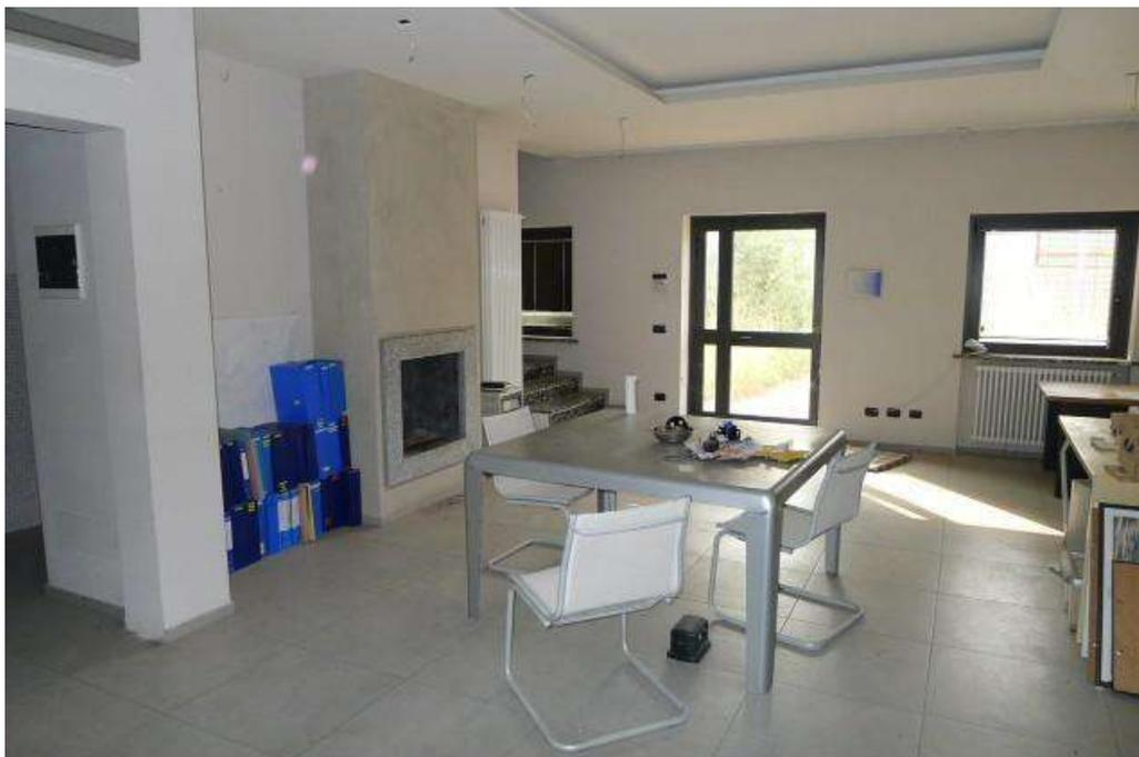
Pavimenti in monocottura, pareti intonacate e tinteggiate, impianti sottotraccia, impianto di riscaldamento con caldaia pensile e termosifoni. Scala in pietra vulcanica lucida.
